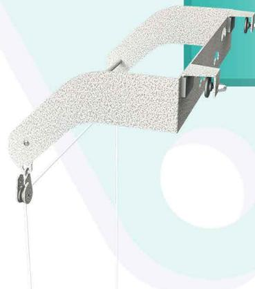
AUTOPASIVO (REF. 2031) CON UNOS ACOPLES QUE LO PERMITEN COLGAR DE LA PARTE SUPERIOR DE LA PUERTA EVITANDO AGUJEROS EN LA PARED. FÁCIL Y RÁPIDO MONTAJE Y DESMONTAJE. LA PUERTA NO DEBE TENER MOLDURA NI CRISTAL EN LOS 10 CM SUPERIORES DE LA MISMA, QUE ES DONDE APOYARÁ EL AUTOPASIVO. EL ACOPLE DEL AUTOPASIVO A LA PUERTA MIDE 3MM DE ESPESOR, ESPACIO QUE DEBE HABER ENTRE LA PUERTA Y EL MARCO.
